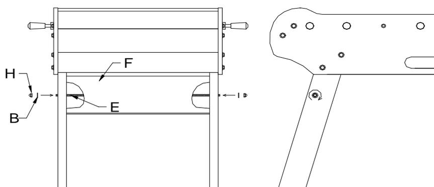
Positionner les traverses en les glissant par le bas entre les pieds, insérer et visser les tiges filetées puis finaliser le vissage des pieds. Ne pas serrer trop fort pour ne pas endommager le placage !
