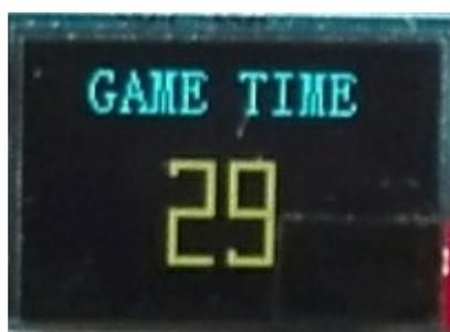
Die Anzeigen bleiben während des Spiels die ganze Zeit eingeschaltet und zählen in Minuten bis zum Ende des Spiels herunter. Das OLED-Display zeigt die Spielzeit bis zu 999 Minuten als Ziffern an und darüber erscheint "HIGH". Bei der 1x7LED-Anzeige werden die Ziffern bis zu 9 Minuten dargestellt. Darüber erscheint der Buchstabe "H". Nach Ablauf des Countdowns geht das System in den Ruhezustand über.
